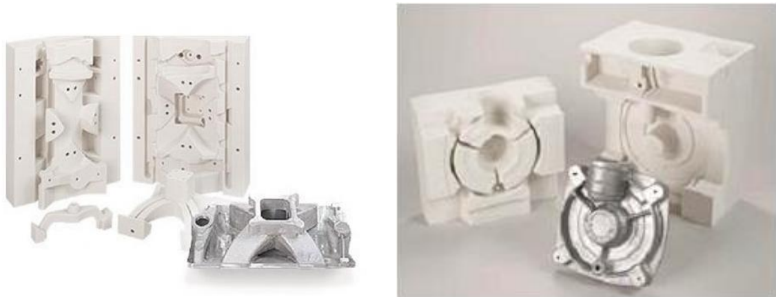
图 12-2 Zcast 法制作的石膏型和铝合金铸件
